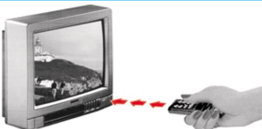
Fig.127 Nei radiocomandi per TV si utilizzano dei fotodiodi all'infrarosso.
