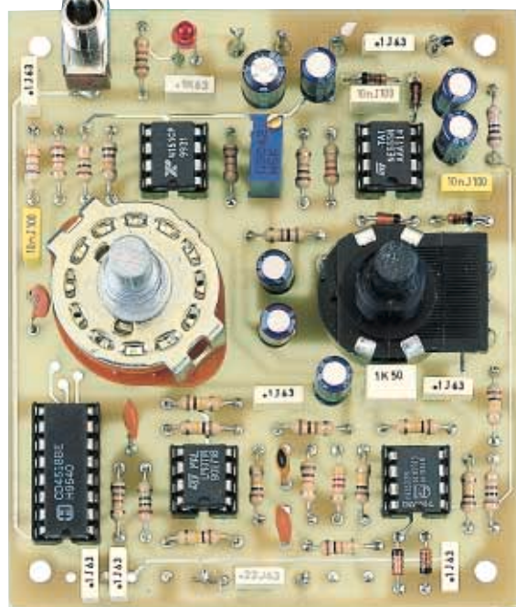
Fig.567 Foto del circuito stampato del frequenzimetro analogico con già sopra montati tutti i componenti. La vite posta sul corpo del trimmer multigiri R17 è quella del cursore di taratura.
