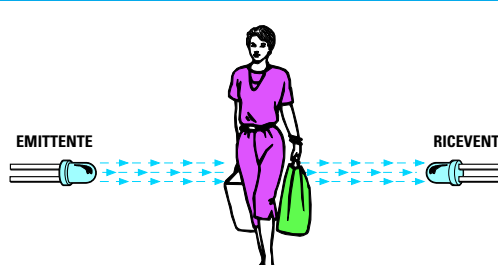
Fig.128 I fotodiodi vengono utilizzati per realizzare apriporte - antifurti - contapezzi.
