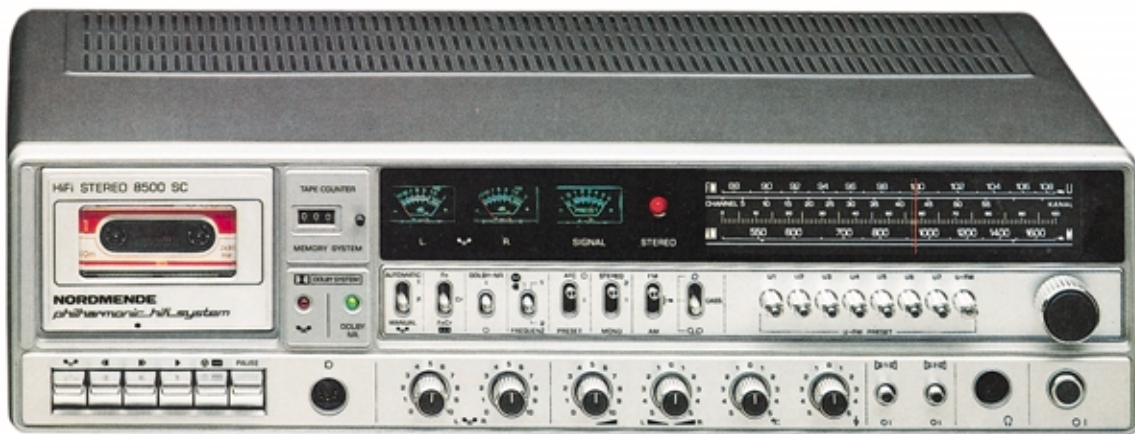
Fig.314 Una radio moderna è in grado di ricevere le emittenti che trasmettono sulle onde Medie - Corte in AM e quelle che trasmettono in FM Stereo nella gamma VHF. In molti ricevitori è installato anche un registratore a nastro oppure un Compact Disk.
