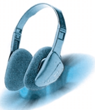
Fig.185 Le cuffie sono dei minuscoli altoparlanti che si appoggiano sulle orecchie per ascoltare individualmente della musica. Le cuffie hanno una "impedenza" di 32 oppure di 600 ohm.
