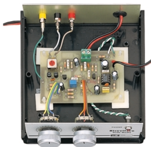
Fig.362 Per fissare la bassetta del ricevitore all'interno del mobile, dovrete inserire nei quattro fori presenti nel circuito stampato i perni dei distanziatori plastici che troverete inclusi nel kit.
