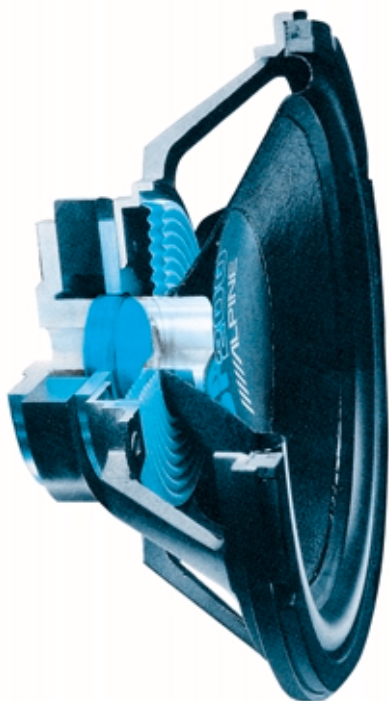
Fig.174 Sull'estremità del cono di un altoparlante è applicata una bobina che scorre dentro un magnete. Applicando una tensione alternata a questa bobina il cono oscillerà alla stessa frequenza.
