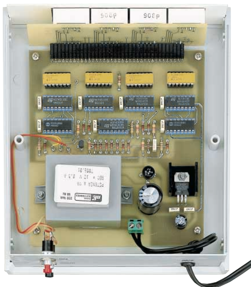
Fig.282 Dopo aver inserito il connettore femmina presente sullo stampato LX.5035/B sul connettore maschio presente sullo stampato LX.5035 potrete fissare il tutto all'interno dell'elegante mobile che vi verrà fornito su richiesta.
