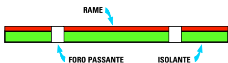
Fig.151 Vengono chiamati circuiti stampati MONOFACCIA quelli che hanno le piste in rame poste da un solo lato della bassetta isolante utilizzata come supporto. I circuiti stampati professionali utilizzano come supporto isolante la vetronite.
