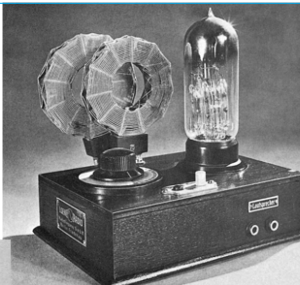
Fig.340 Negli anni 1925-1940 era molto diffuso un semplice ricevitore radio a cuffia chiamato a "galena" perché usava come rivelatore di segnali un minerale di solfuro di piombo contenente un 2% circa di argento.
