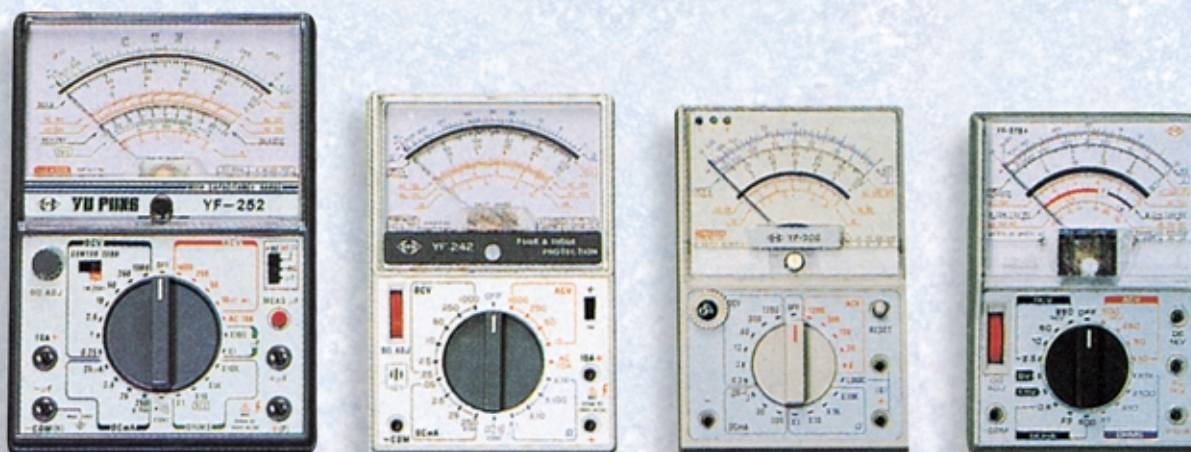
Fig.365 Se un giorno decideste di acquistare un Tester Analogico, sceglietene uno che abbia una sensibilità non inferiore a “20.000 ohm x volt” per ridurre gli errori di lettura.
