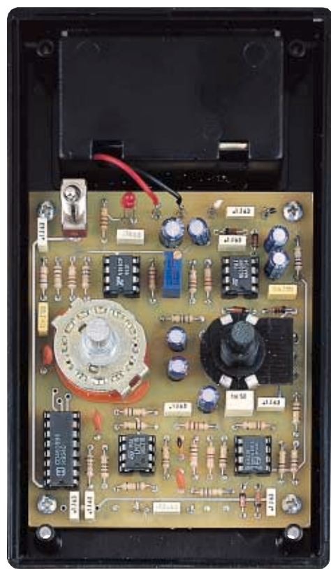
Fig.570 A sinistra, il circuito stampato fissato nel mobile con quattro viti autofilettanti. Nel vano presente nella parte alta del mobile troverà posto la pila da 9 volt.
